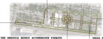
THE BUILDINGS WERE CHANGED AND RESIZED TO ALLOW FOR ALL OF THE PARKING TO BE LOCATED ON THE GROUND LEVEL. THE LARGER STORES ARE LOCATED ON THE NORTH SIDE OF THE SITE, WITH SMALLERE BUISINESS SURROUNDING THEM, AND ALONG THE CENTRAL AXIS STREET.
